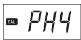
Нажать на кнопка CAL (Калибровка) и удерживать его в течение 0,5 секунды
