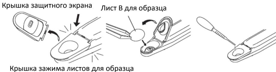
**Прим.** Крышка зажима листов для образца не защищает датчик от света, который может оказывать воздействие на него. При использовании крышки зажима листов для образца использовать альтернативное средство защиты плоского датчика от света.
