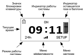
Рис. 1. Шкала расхода (только в модели GC)
