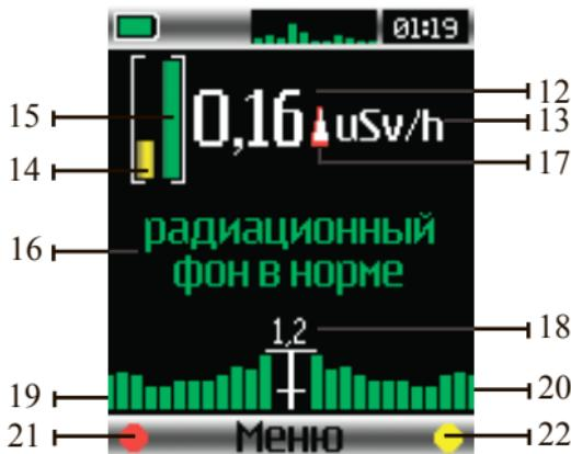
12. Уровень радиоактивности. Отображается крупными цифрами в центре экрана. При первом измерении отображается слово «ИЗМЕРЕНИЕ».
