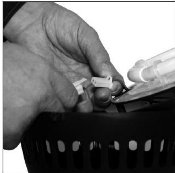
Разъедините коннектор (коннектор вентилятора и выключателя).
