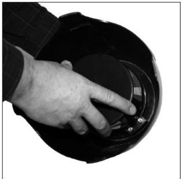
Для очистки контейнера-ловителя, поверните его против часовой стрелки.
