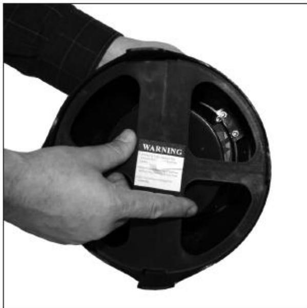
Поверните нижнюю пластину против часовой стрелки.
