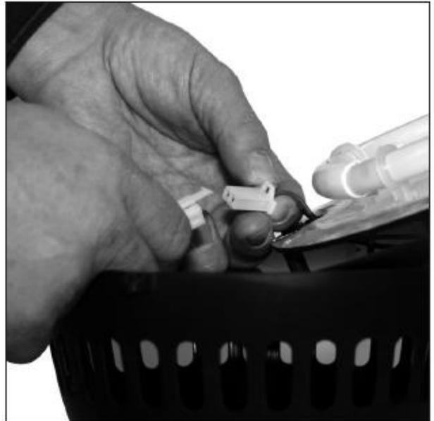
Разъедините коннектор (коннектор вентилятора и выключателя).
