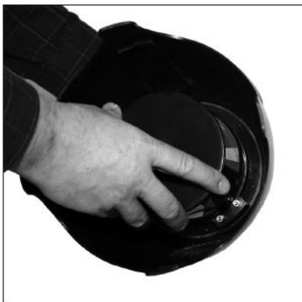
Для очистки контейнера-уловителя, поверните его против часовой стрелки.
