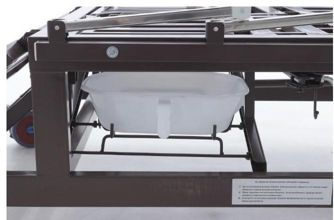
Б) При необходимости отрегулируйте ход туалетной секции: извлеките шплинт на конце тяги туалетной секции, выведите тягу из зацепления с пластины поворотной трубы и вкручивайте или выкручивайте её для регулировки плотного закрытия туалетной секции. Добившись нужного положения, снова вставьте конец тяги в отверстие пластины поворотной трубы и зашплинтуйте его.
