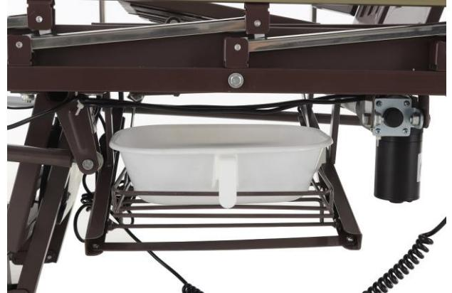
Б) При необходимости отрегулируйте ход туалетной секции: извлеките шплинт на конце тяги туалетной секции, выведите тягу из зацепления с пластиной поворотной трубы и вкручивайте или выкручивайте её для регулировки плотного закрытия туалетной секции. Добавившись нужного положения, снова вставьте конец тяги в отверстие пластины поворотной трубы и зашплинтуйте его.
