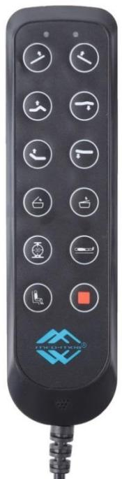
6. Подключите кровать к электросети и проверьте правильность подключения коннекторов к блоку, нажимая на пульте кнопки поднятия и опускания икроножной секций и спины (Пульт оснащён интуитивно понятными пиктограммами). При необходимости поменяйте коннекторы местами.
