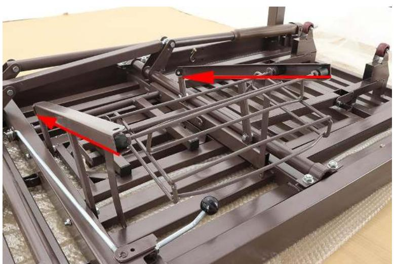
3. Закрепите тяги подставки туалетного судна к лючку открывания туалетного устройства болтами с гайками входящими в комплект. До упора не затягивайте, оставьте зазор в 3 мм. Для хода.
