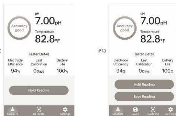
На этом экране вы можете нажать кнопку Hold Reading «Удержание показаний», чтобы зафиксировать показания, или нажать кнопку Save Reading «Сохранить показания», чтобы сохранить текущие показания для будущего использования. Функция сохранения измерений доступна только в версии Pro.
