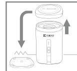
② Проверьте чистоту генератора водорода
