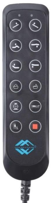
6. Подключите кровать к электросети и проверьте правильность подключения коннекторов к блоку, нажимая на пульте кнопки поднятия и опускания икроножной секций и спины (Пульт оснащен интуитивно понятными пиктограммами). При необходимости поменяйте коннекторы местами.
