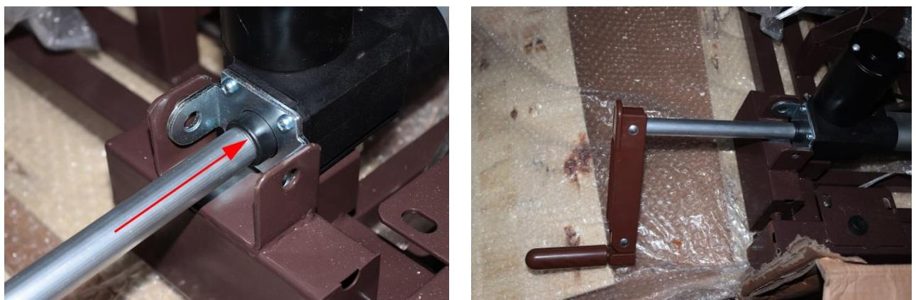
2. Вращайте ручку гибридного привода против или по часовой стрелке до тех пор, пока отверстия в кронштейне линейного актуатора не совместятся с отверстиями в кронштейне крепления актуатора на раме кровати. Соедините кронштейны болтами с гайкой. Верните заглушку линейного актуатора на место.
